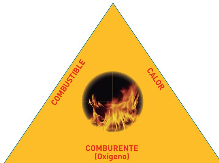
Figura 6: Triángulo del fuego.
